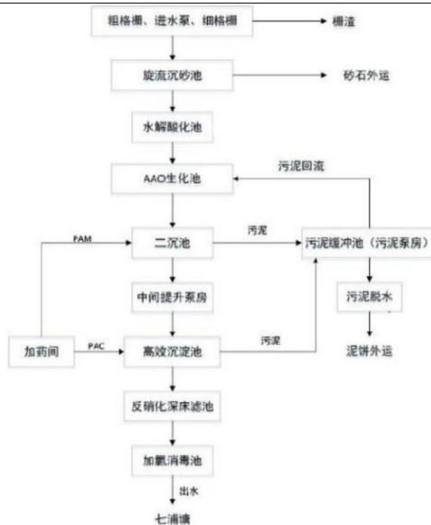
图 4.2-2 沙溪污水处理厂处理工艺流程图
