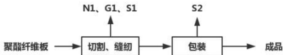
图 2-3 聚酯纤维吸音板加工生产工艺流程图
